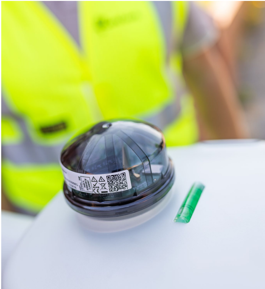
De communicatiemodule is het kapje dat je bovenop de lamp ziet zitten.
